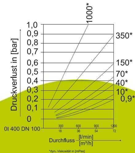
Druckverluste für Ovalräder mit Kugellagerung (Messstoffe mit Newtonschem Fließverhalten oder strukturviskose Flüssigkeiten mit nicht Newtonschem Fließverhalten): bitte Anfrage
