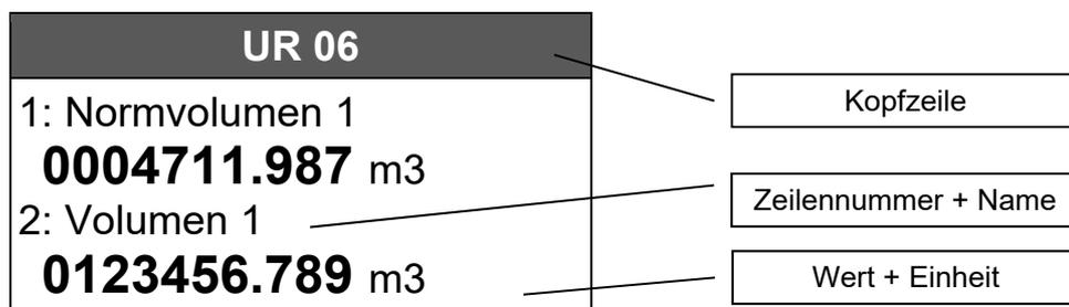
Bei gestörten Messwerten oder konstanten Vorgabewerten wird zusätzlich ein Symbol eingeblendet, damit diese Werte besser von lebenden Messwerten unterschieden werden können.
