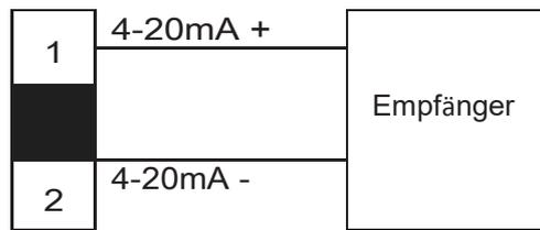
Der Stromausgang des Konverters ist galvanisch getrennt. Es handelt sich um einen aktiven 4 - 20 mA-Ausgang, wobei 20 mA dem maximalen Durchfluss entspricht, der am Gerät eingestellt ist. Der maximale Lastwiderstand des Stromausgangs beträgt 750 Ω einschließlich des Lastwiderstands des verwendeten Kabels. Empfohlenes Stromausgangskabel ist RWP2 x 16/015 PVC-isolierte Mantelleitung mit Schirm.
